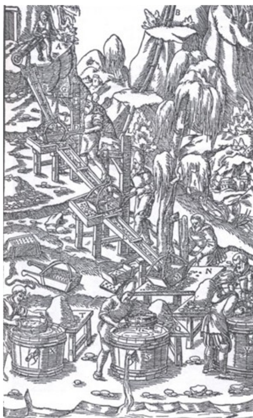
Fig. 6. Separação gravítica do minério (HOOVER & HOOVER 1950: 291).
